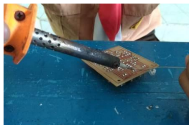
Gambar 1. Alat dan bahan pembuatan alat Proses penyolderan driver sensor ultrasonik
